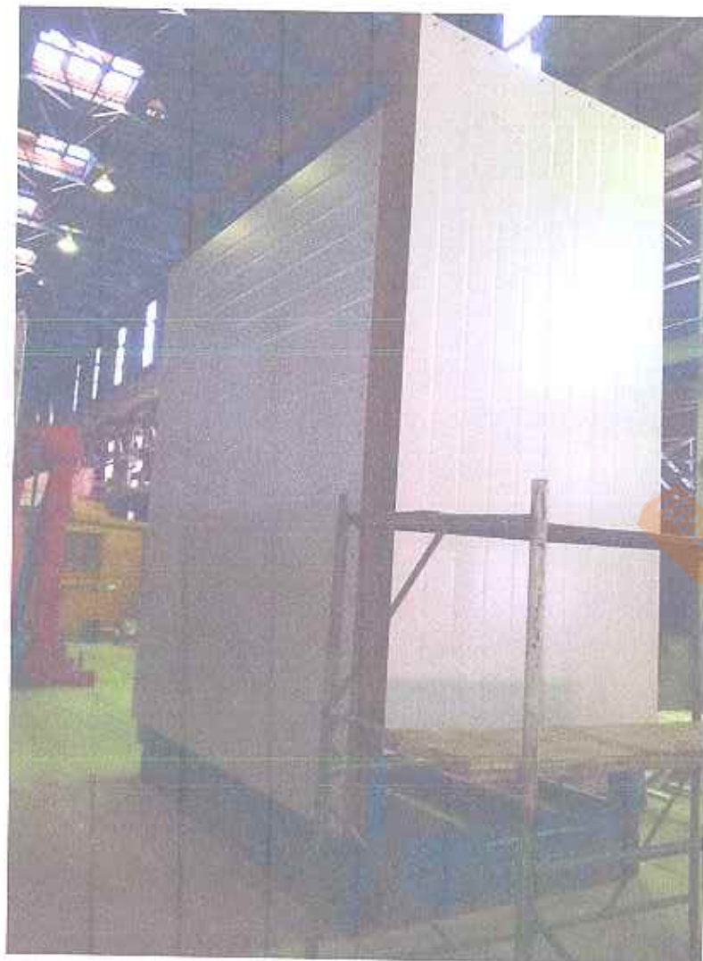
Рис. 3.1 Общий вид пространственного стального каркаса с закрепленными при помощи самосверлящих шурупов сэндвич-панелями.
